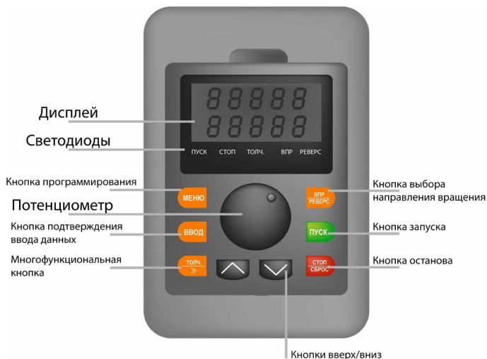
Рис. 5.1.1 Функции кнопок и светодиодов панели управления
